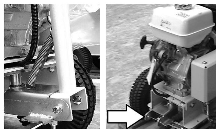
Die Zugstange muss wie in diesen Abbildungen an der Anhängervorrichtung montiert werden.
