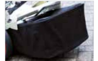
**Fangkorb** – zum Arbeiten mit Fangkorb einfach die selbstschließende Klappe (Schutz gegen Steinschlag) anheben und den Korb einhängen.
