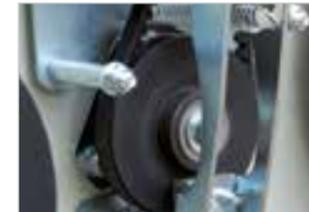
**Keilriemenantrieb** – ein gezahnter Keilriemen treibt die Messerwelle an. Die Kupplungsrolle ist kugellagert.
