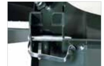
**Bürstenabnutzung** – zur sauberen Aufnahme des Kehrichts lässt sich der Kehrgutbehälter entsprechend der Bürstenabnutzung einstellen.
