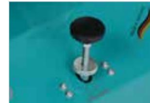
**Höhenverstellung** – die Vertikutiertiefe ist präzise über die Skala einstellbar, optimale Arbeitstiefe: 2–3 mm.
