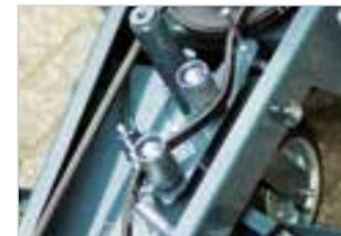
**Geschwindigkeit (KM H)** – einfaches Umliegen des Keilriemens verdoppelt die Bürstengeschwindigkeit von langsam für Schmutz auf schnell für Schnee.
