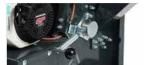
**Siebhebel** – zum öffnen und schließen.
