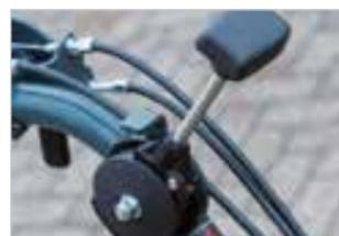
**Variator** – eine runde Sache, Bürstengeschwindigkeit stufenlos verstellbar.
